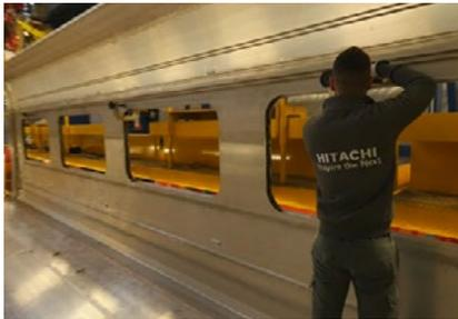
I materiali e i semilavorati che andranno a comporre il prodotto sono assemblati attraverso processi di saldatura tradizionale e friction stir welding (FSW), un innovativo processo di saldatura per attrito allo stato solido.
