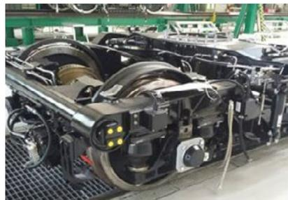
Linea dedicata alla realizzazione dei carrelli attraverso lavorazioni di carpenteria metallica e di meccanica. I carrelli realizzati sono inviati agli altri stabilimenti del gruppo per il montaggio sui rotabili.
