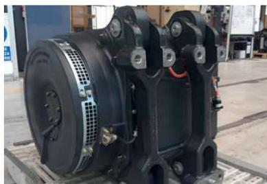
Linea dedicata alla realizzazione dei motori elettrici di trazione. Il motore viene completamente realizzato presso i nostri impianti partendo dal montaggio meccanico fino alle fasi di avvolgimento e di impregnazione. I motori realizzati saranno successivamente montati sul materiale rotabile in altre sedi del Gruppo.
