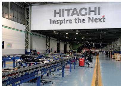
Nella fase di allestimento si procede all'installazione di tutti i materiali, dei semilavorati e dei componenti all'interno della cassa. Questo step prevede il montaggio meccanico, il cablaggio, l'incollaggio e la sigillatura delle varie componenti al fine di ottenere un prodotto finito curato in ogni minimo dettaglio.
